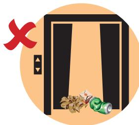
Ne jetez aucun déchet au sol dans la cabine, ils peuvent ensuite se retrouver dans les rainures des portes et les bloquer
